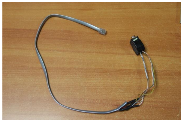
Figure 1: le câble construit à partir de récupérations
